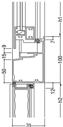
**7** インベイ内倒し排煙／片開きドア・両開きドア
