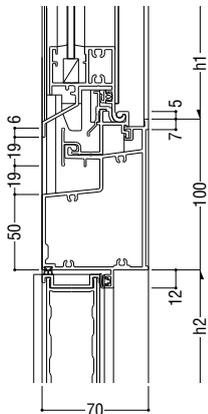
**6** 突出し排煙（インベイと共通）／片開きドア・両開きドア
